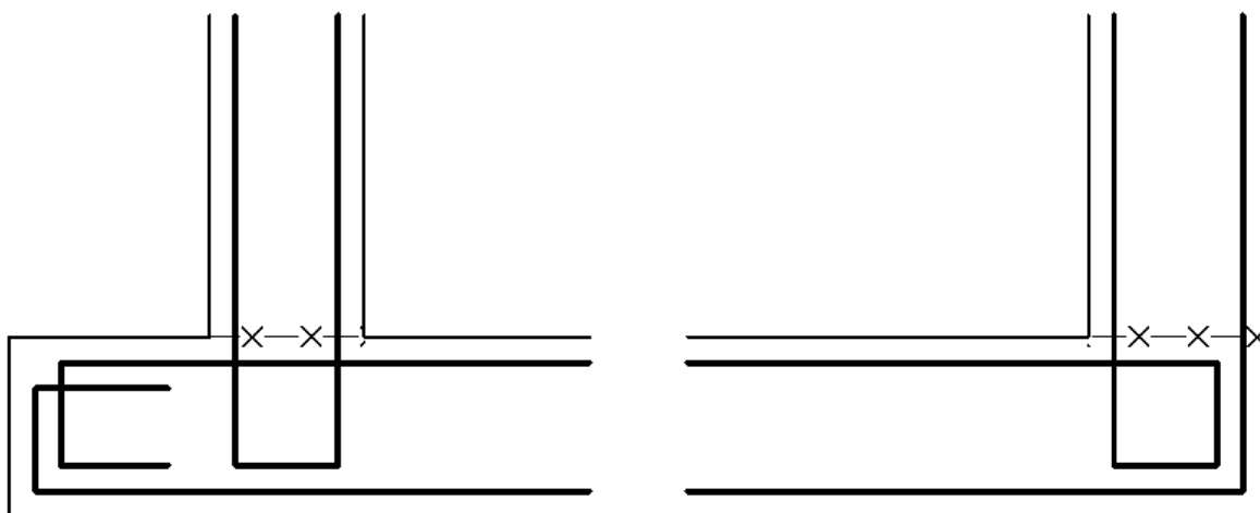
Schéma napojení desky na stěnu
